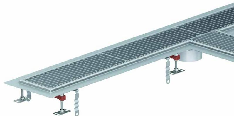
Die ACO Kastenrinne ist auf ein höchstes Maß an Flexibilität der Konstruktion entwickelt worden. So kann trotz Stich- oder Winkelform eine minimale Installationshöhe erreicht werden, um auch schwierige Einbausituationen zu lösen. Rinnenlänge 6 m am Einzelteil und 800 mm Breite. Einbauhöhen ab 30 mm am Endstück sind hier machbar.
