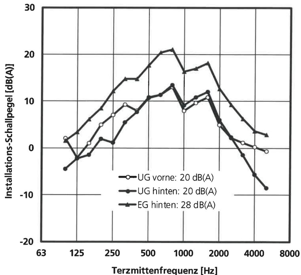
Frequenzverlauf des Installations-Schallpegels bei Geräuschanregung mit dem Körperschall-Geräuschnormal (KGN), gemessen in den Räumen UG vorne, UG hinten und EG hinten. In der Legende sind die Installations-Schallpegel  $L_{A\text{F}eq,n}$  in dB(A) nach DIN 4109 für den abgebildeten Frequenzbereich von 100 bis 5000 Hz angegeben.
