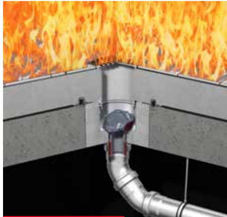
Bodenablauf mit aktiviertem Brandschutz
