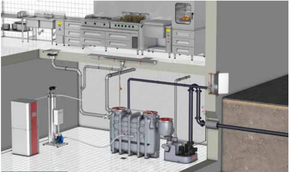
ACO Fettabscheider mit kombinierter Wärmerückgewinnung ACO Liputherm
