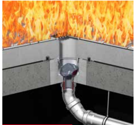
Bodenablauf mit aktiviertem Brandschutz
