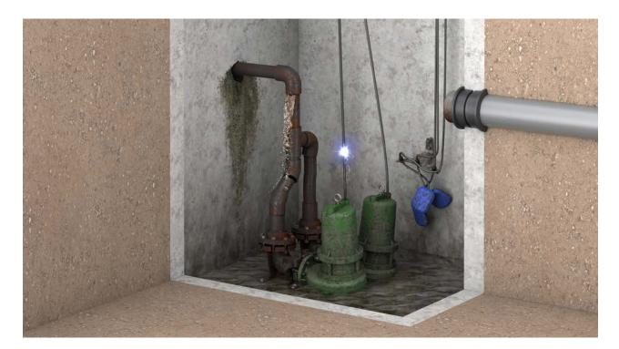
Aufgrund von konstruktiven Gegebenheiten ist es in Gewerbe- oder Wohnbauten oftmals nicht möglich, Pumpenschächte in Boden- oder Kellerplatten einzusetzen. Zur Ableitung von verschiedenen Abwässern werden daher Betonschächte in den Bodenaufbau eingeplant und ausgeführt. Sind in diesen bauseitigen Betonschächten nun Pumpanlagen einzuplanen, so ist dies oft mit erheblichen Planungs- und Montageaufwand verbunden:
