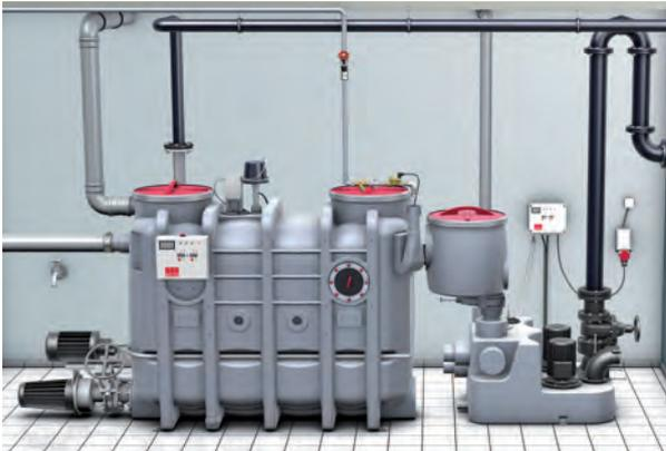
Abwasserhebeanlagen dienen der Förderung von Abwasser über die Rückstauenebene in die höher liegende Kanalisation. Der Einsatz von Abwasserhebeanlagen ist gemäß DIN 1986-100 und DIN EN 12056 für Ablaufstellen unterhalb der Rückstauenebene vorgeschrieben, demnach bei fast allen frei aufgestellten Fettabscheidernanlagen. Je nach Einsatzbereich bietet ACO eine Auswahl an verschiedenen Abwasserhebeanlagen die direkt hinter den Fettabscheidern montiert werden können.
