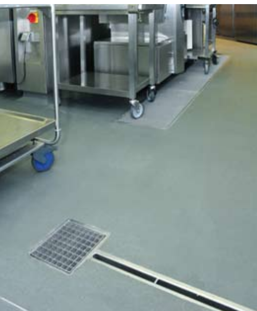
ACO Schlitzrinne Variant-CR aus Edelstahl mit einem Anschlussstützen und Aufsatzstück mit rutschhemmenden Gitterrost der Belastungsklasse M125
