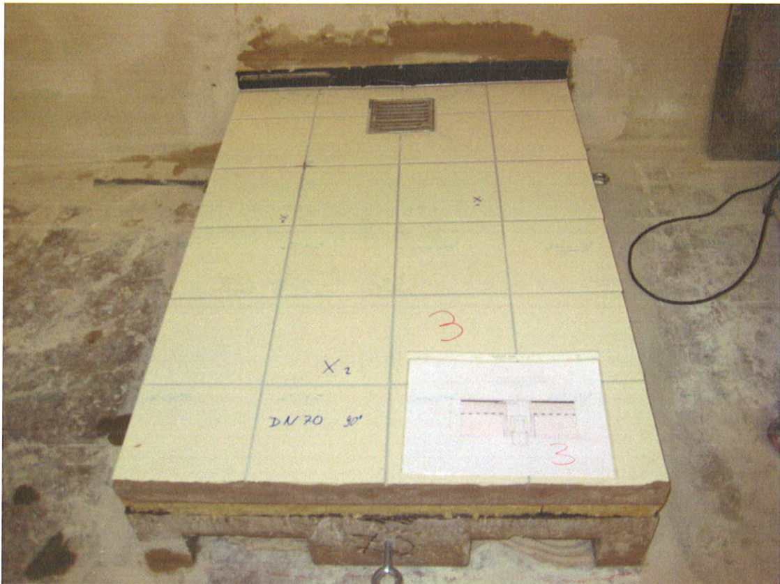
Ablaufkörper aus Gusseisen Aufsatzstück aus Kunststoff DN 70 Fit-In 90° Ablauf
