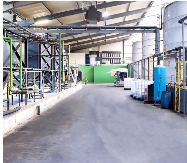
Reaktoren für die Spaltung pflanzlicher Fette in einer Biokraftstoffanlage
